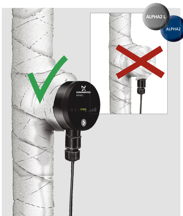
Obr. 5 Izolácia telesa čerpadla
