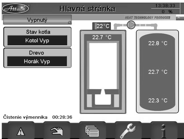
Obr. 21 Po zvolení TEST módu sa na dolnej lište zobrazí symbol ruky, kde je možné otestovať všetky elektrické zariadenia pripojené k elektronike
