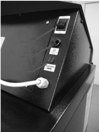
Obr. 17 1 – hlavný vypínač, 2 – havarijný termostat, 3 – poistka (F6,3A)
